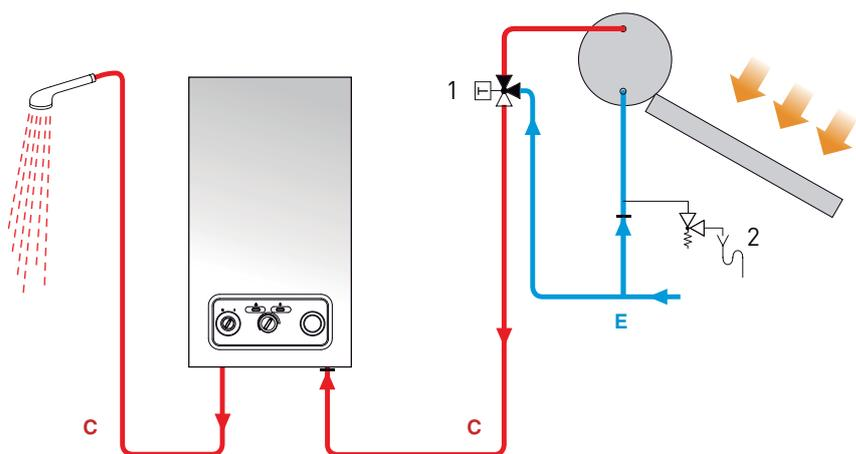
Kit solar con válvula termostática (3024085) que permite la integración solar de forma fácil y práctica con un ajuste de temperatura hasta los 60°C.
