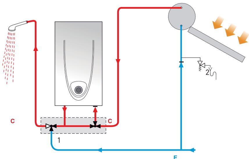
El kit solar con válvula termostática con by pass (3632077) permite al calentador no arrancar en caso de que la temperatura del agua del solar sea mayor que 48°C.
